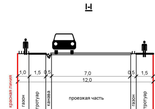
Поперечное сечение улиц М 1:200
